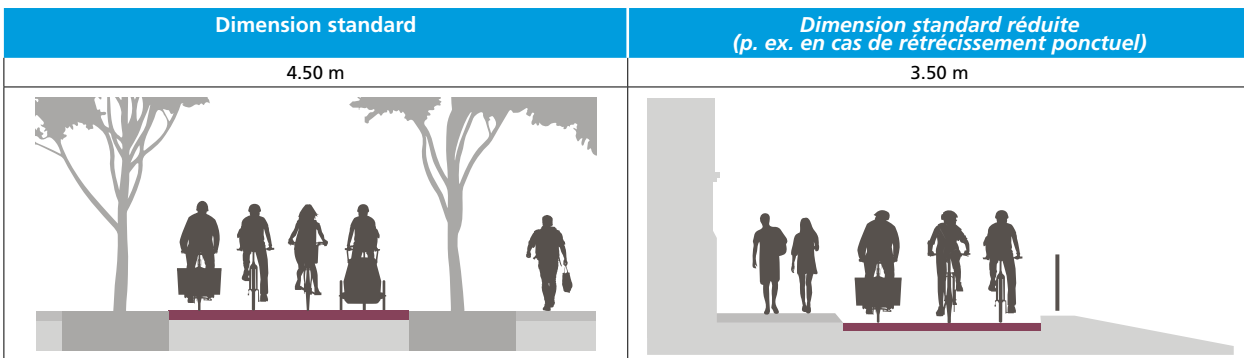
Fig. 6-2 : Piste cyclable bidirectionnelle – Largeurs et cas de croisement possible
