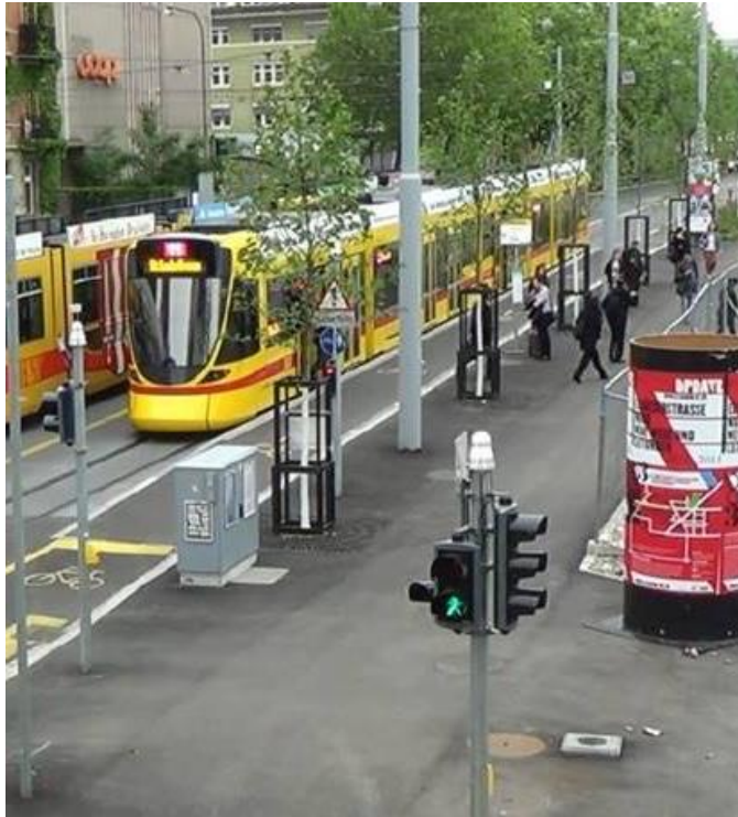
Im Bild fehlt die Haltestellenmöblierung, dennoch ist der Wartebereich und die Sicht auf Velos eingeschränkt
