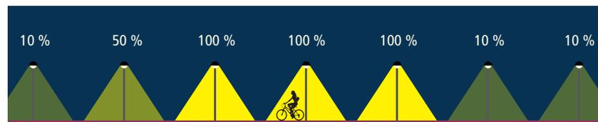
Abb. 9-1: Intelligentes Beleuchtungssystem (Masterplan für die Velobahn «Sporbaanpad», Almere Niederlande)
